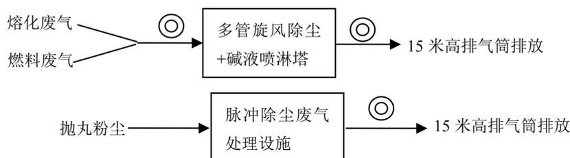
图6-2 有组织废气监测点位示意图
