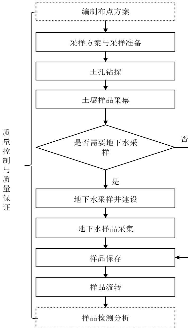
图 1-2 自行监测现场采样工作程序
