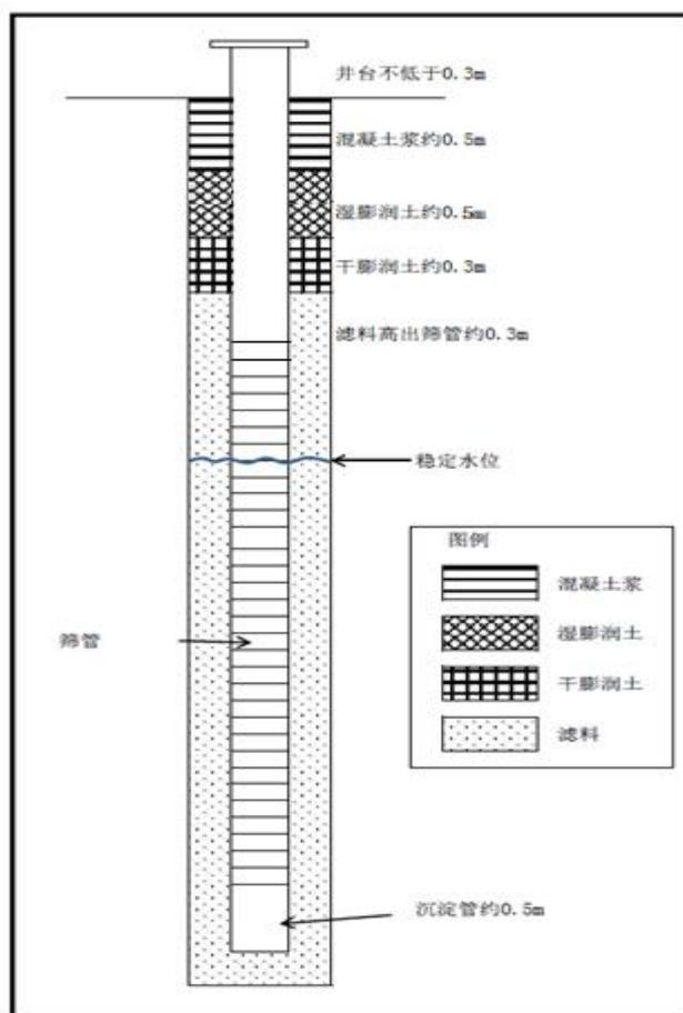
图 7-1 地下水采样井结构示意图
