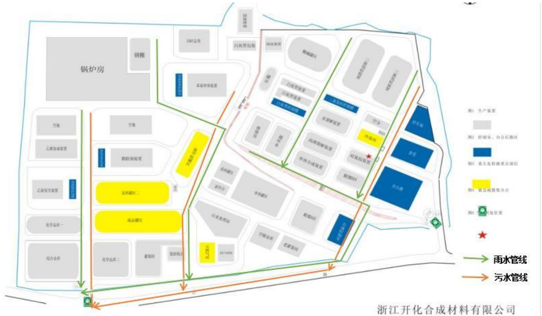
图 4.2-2 厂区雨污水管网图
