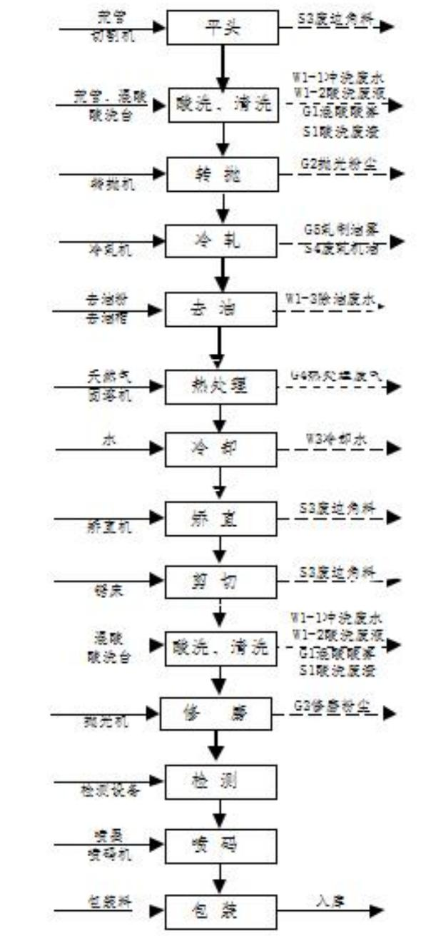
图 4-1 无缝管冷轧生产工艺流程图
